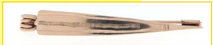
Aus einem Stück Draht wird ein Teil dünn zu einer Nadel gezogen, der größere Teil wird zu Vorderteil breit geschmiedet und an der Spitze das Material so dünn geschmiedet, dass man es umbiegen kann.
